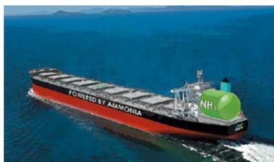
アンモニア燃料大型ばら積み船イメージ図
