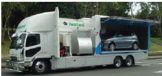
試乗会用に開発した「専用キャリアカー」 燃料電池自動車と小型ステーションが同時に運べる
