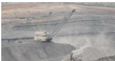
ドラッグライン（左）で地表の土を取り除き、エクスカベーター（右）で石炭を掘り出す。ドラッグラインは高さ64m、重さ5,666t、腕の長さ119m、バケット容量65m 3 、価格5,600万豪ドル
