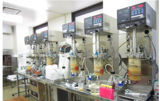
研究開発に使用するジャーファーマメーター(微生物培養装置)
