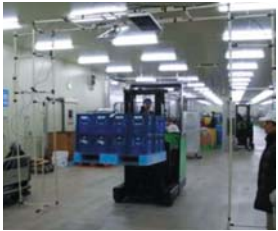
①フォークリフトによる一括読み取り実験 (UHF帯)
