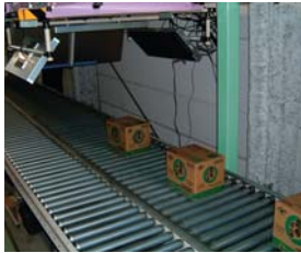
②コンベア搬送時一括読み取り実験 (UHF帯)
